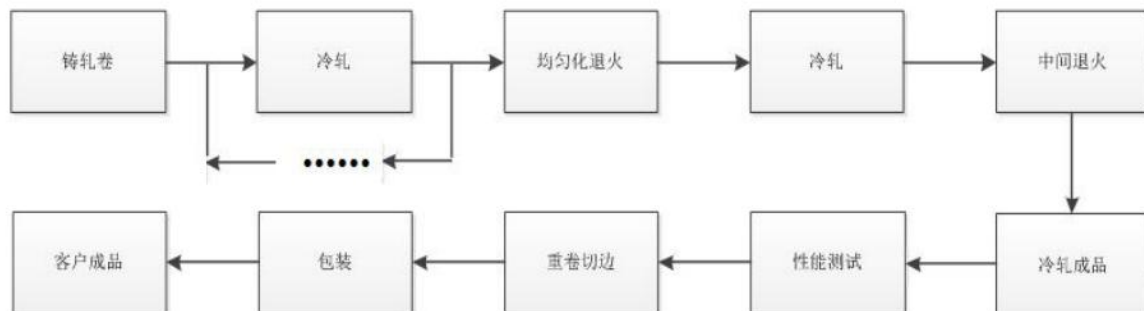
附图 1.5-2 冷轧车间工艺流程图
