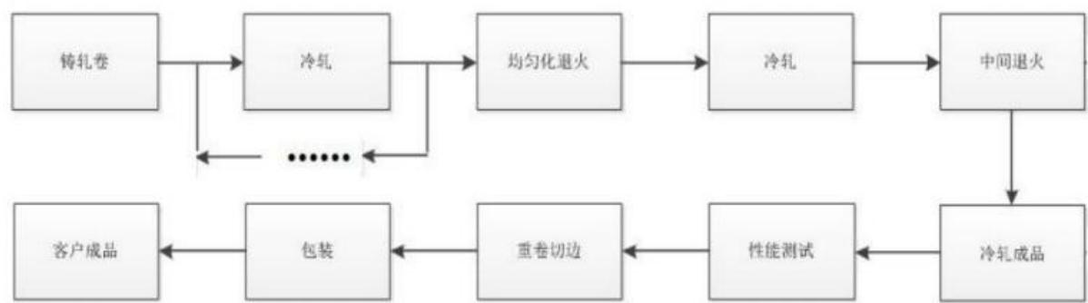
图 1.5-2 冷轧车间生产工艺流程图
